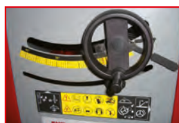
Sägeblatthöhenverstellung saw blade height adjustment
