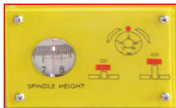
präzise Spindel Höhenanzeige precise spindle height indication
