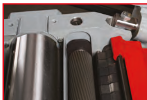
spiralverzahnte Einzugswalze spiral-toothed infeed roller
